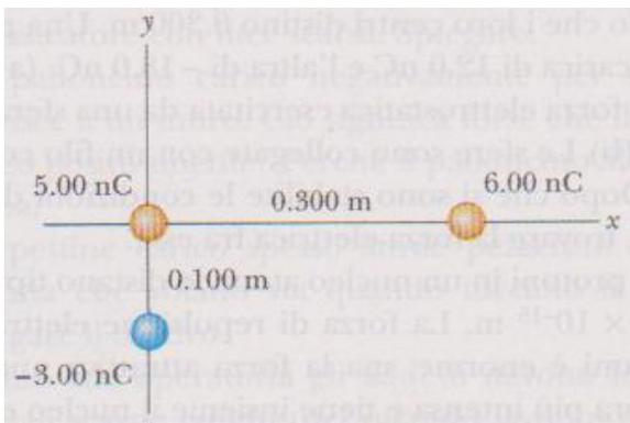
Tre cariche puntiformi sono sistemate come in figura. Trovare il campo elettrico che le cariche di  $6,00\text{nC}$  e  $-3,00\text{nC}$  creano nell'origine; trovare il vettore forza agente sulla carica di  $5,00\text{nC}$
