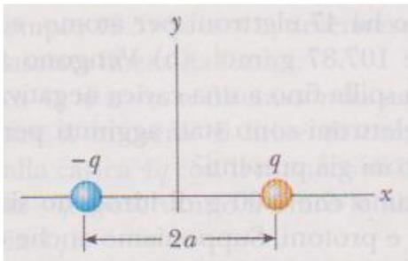
Si consideri il dipolo elettrico mostrato in figura. Si dimostri che il campo elettrico in un punto distante lungo l'asse  $x$  è dato da  $E_x = 4k_e qa/x^3$
