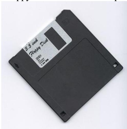
Floppy disk a doppia densità, da notare i due forellini in basso ai lati del disco. Un foro ha una piccola placca che scorre e permette di aprire o chiudere la finestrella. È un meccanismo di protezione:
