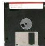
Un floppy disk ha una struttura simile a quella dell’hard disk, solo che ha un solo disco, di materiale magnetizzato sulle due superfici protetto da una custodia di plastica. Per accedere alla superficie del disco bisogna spostare la placca metallica. A questo punto, le due testine vanno a contatto con il disco e leggono le informazioni.
