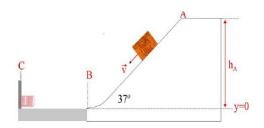
Un blocco di massa m=2Kg inizialmente a riposo nella posizione A si muove lungo una superficie scabra AB inclinata di 37° e che presenta un coefficiente di attrito  $\mu_d$ =0,1 ed è lungo 2 metri. Successivamente si muove lungo una superficie orizzontale BC, incontrando una molla di costante elastica k=800N/m.
