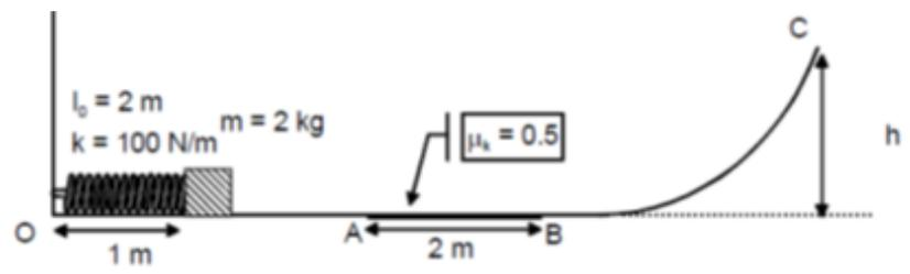
Un blocco di massa  $2 \text{ Kg}$  sta comprimendo di  $1 \text{ metro}$  una molla di costante elastica  $100 \text{ N/m}$  e di lunghezza a riposo di  $2 \text{ m}$ . La molla mette in accelerazione il blocco su una superficie liscia (tranne che nel tratto  $AB$  dove la superficie ha un attrito e il coefficiente di attrito cinetico è  $0.5$ ); dopo il tratto scabro, il blocco prosegue su una superficie curva come indicato in figura. Si determini:
