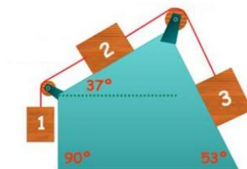
I blocchi mostrati in figura hanno masse rispettivamente  $m_1 = 3 \text{ Kg}$ ,  $m_2 = 1 \text{ Kg}$ ,  $m_3 = 2 \text{ Kg}$  e sono collegati mediante due corse di massa trascurabile. Il sistema è in moto verso sinistra con accelerazione di modulo pari a  $3 \text{ m/s}^2$ . Si determinino:
