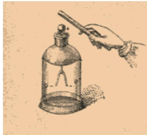
Il pendolino elettrostatico è uno dei più semplici esperimenti per visualizzare le proprietà delle cariche elettrostatiche; si tratta di un dispositivo semplicissimo, realizzabile senza alcuna spesa seguendo il disegno riportato.
